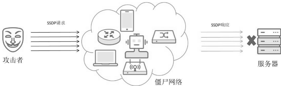
图 8.1.5 SSDP Reflection Flood 攻击原理
