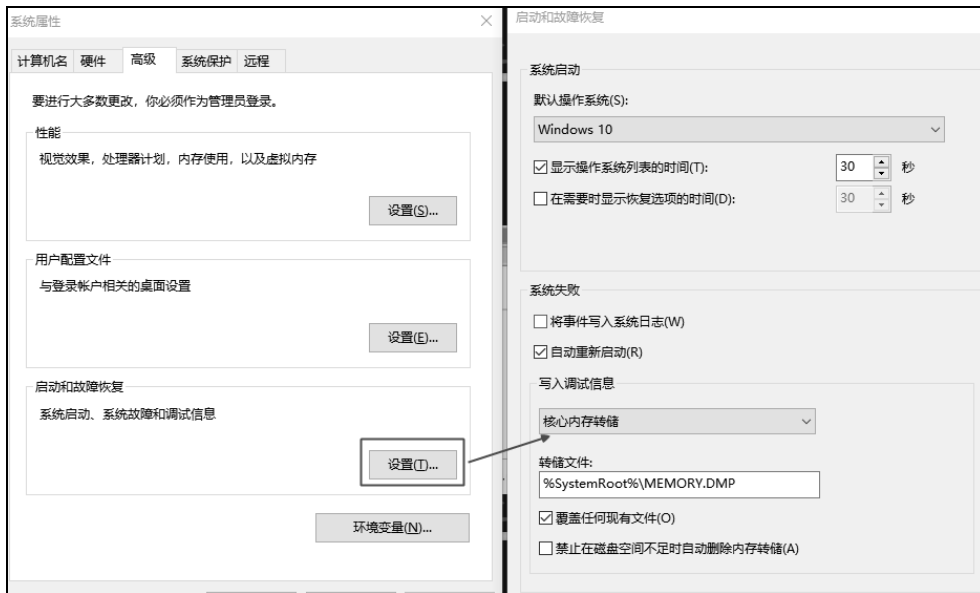
图 2.6.3 基于系统崩溃转储的内存获取
