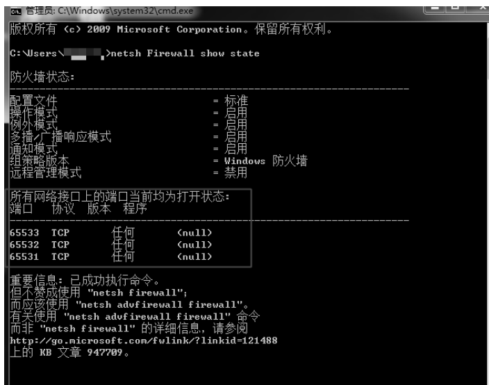
图 2.1.38 当前防火墙的网络配置状态
